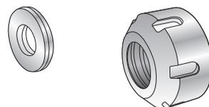
**Руководство по сборке:** Вставьте кольцо в гайку сзади до защелкивания в переднем торце гайки. Маркированная сторона кольца должна быть направлена внутрь гайки во избежание стирания маркировки диаметра. Для освобождения нажмите на переднюю сторону кольца.
