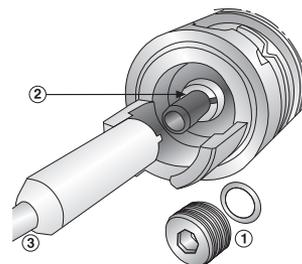
**Трубки для СОЖ**, сделаны из двух частей и включают два одинаковых уплотнения, допускающих небольшое угловое перемещение  $\pm 1^\circ$  (стандартное требование).
