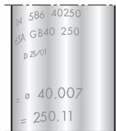
Значения диаметра и длины нанесены лазером на каждой тестовой оправке.
