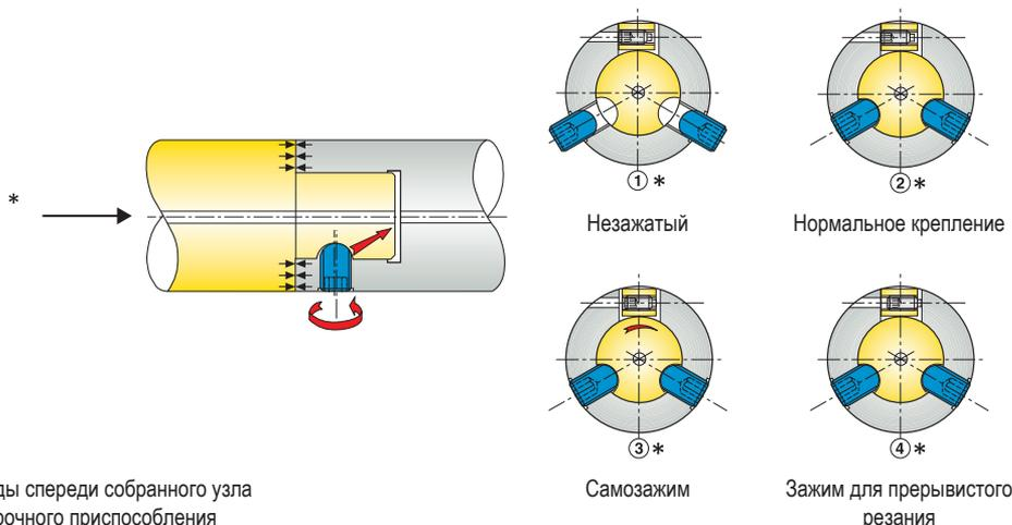
\* Рис.1, 2, 3 и 4 - это виды спереди собранного узла при использовании сборочного приспособления Tool Boy.
