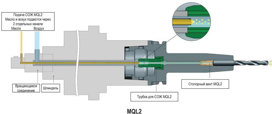
**Держатели MQL, поставляются без дополнительных частей (SFD 5403M) либо укомплектованные для MQL1 (SFD 5403M1) или MQL2 (SFD 5403M2)**
